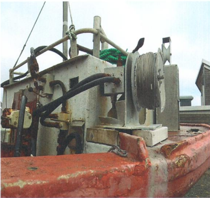
Bilde 4. wiretrommel med wire hvor Vardødorga styres til det ønskede dyp.
