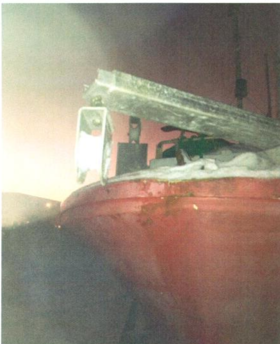
Bilde 5. Utligger på baugen, i bakgrunnen sees trinsen som wiren går gjennom fra wiretrommelen.
